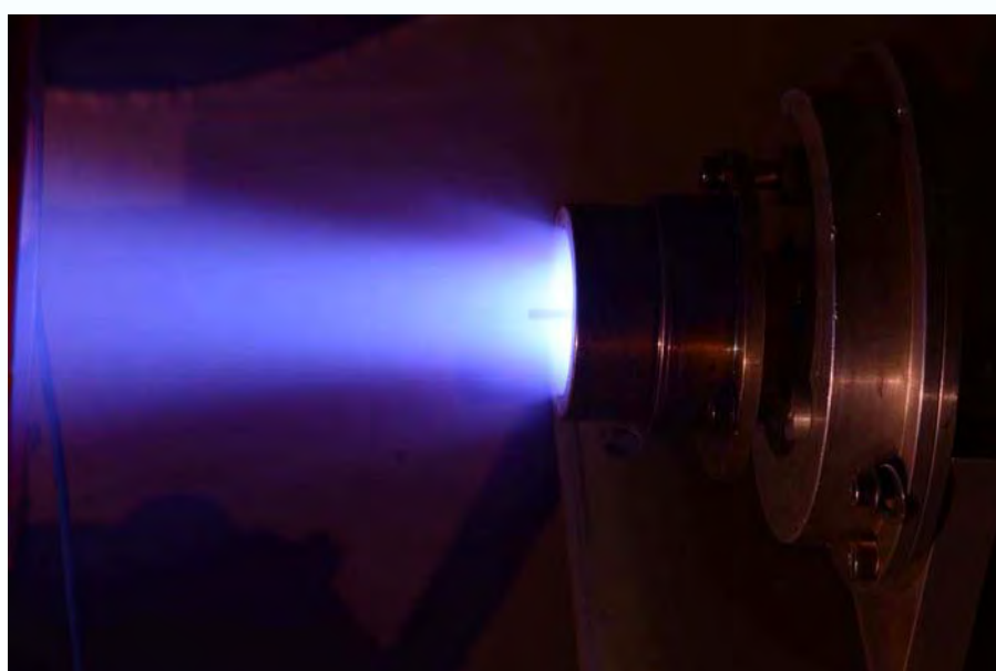
Vue du propulseur ECR en fonctionnement avec du xénon
