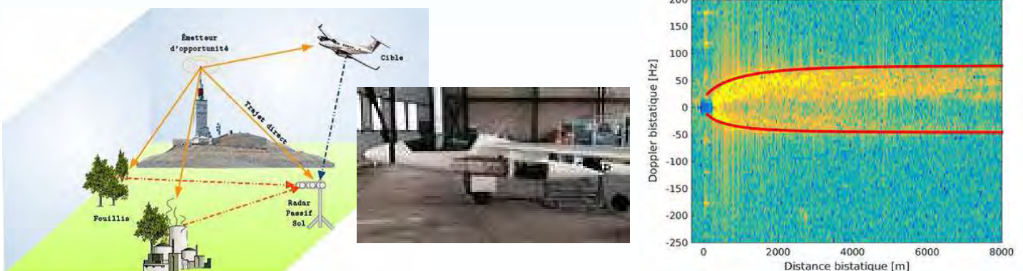
Les contributeurs en radar passif, le porteur utilisé, et exemple d'étalement du fouillis mesuré avec son modèle
