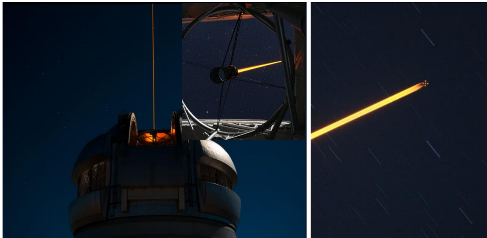
Le télescope Gemini et son laser permettant de produire jusqu'à 5 étoiles artificielles @B Neichel
