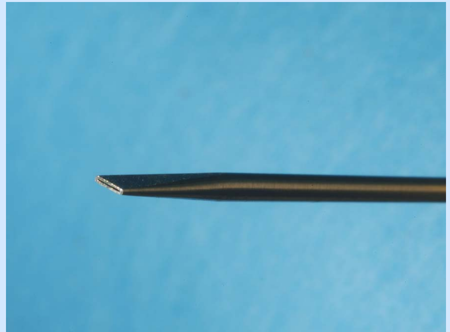
sonde Pitot aplatie pour exploration de couche limite
