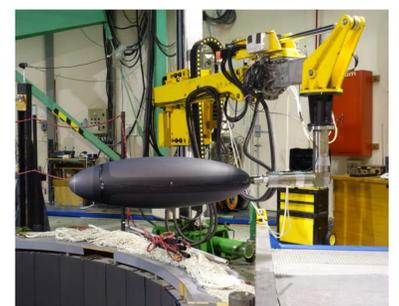
**Banc** pour caractérisation (aérodynamique et acoustique) d'hélice de grande dimension : diamètre jusqu'à 2 m, rotation jusqu'à 1500 tr/min, couple 160 N.m associé avec une **chambre anéchoïque**, compatible avec le support BMS.
