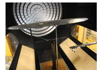
Extraction de traînée par sondage du sillage
