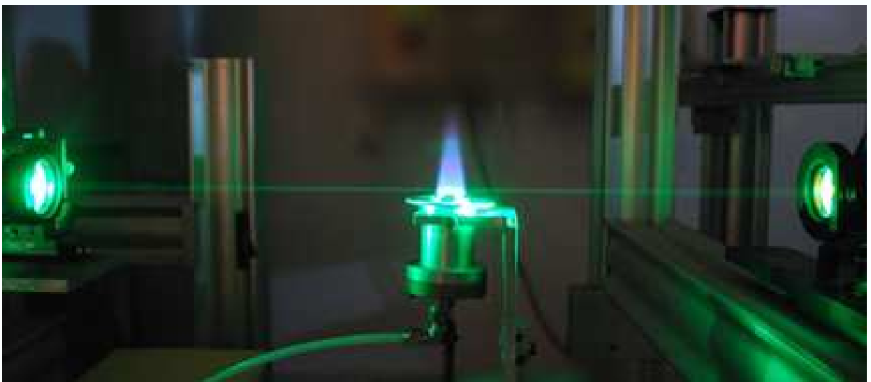
Diagnostic DRASC sur une flamme de prémélange CH_4 /air
