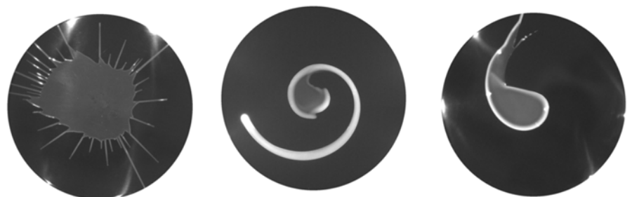
Comportement d'un liquide déposé sur un disque en rotation. De gauche à droite : - Ruisselets axiaux (glycérine pure ( \eta=1400 mPa.s) sur disque poli) - Ruisselet en spirale (eau ( \eta=1 mPa.s) sur disque anodisé) - Ruisselet intermédiaire (eau/glycérine ( \eta=90 mPa.s) sur disque poli)
