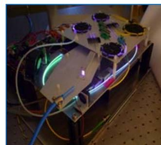
Source laser fibrée ONERA haute énergie pour le lidar vent LIVE.
