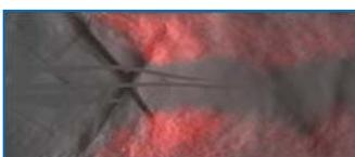
Recherche « stato » : injection transverse d'hydrogène à Mach 1 dans un écoulement jusqu'à 1800 K à Mach 2.
