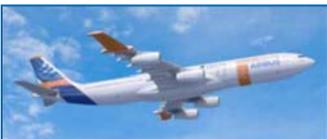
Conduite des essais en vol du démonstrateur Blade A340-300 munis de deux manchons laminaires aux extrémités de voilure (CleanSky 2, avec Airbus, Dassault Aviation, DLR, Saab).
