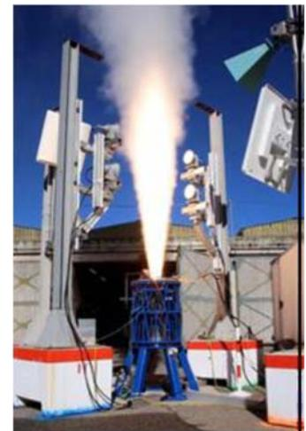
Caractérisation des signatures infrarouge et radar de jets de moteurs à propulsion solide (projet PROPILEX) au Fauga-Mauzac
