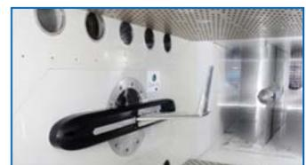
Tests de stabilité aéroélastique de nouvelles configurations d'empennage (S2MA)
