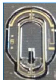
Gyromètre accéléromètre à haute résolution ROSA (quartz)
