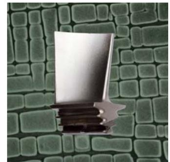
Aube de turbine et microstructure du superalliage base nickel
