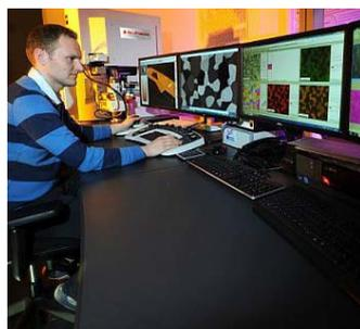
MEB et microanalyses (EDS-WDS-EBSD) pour l'étude de la microstructure et de la chimie des alliages
