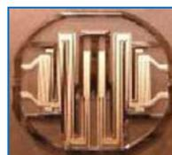
Gyromètre VIG constitué d'un diapason central et d'un système de découplage (quartz)
