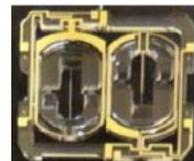
Accéléromètre différentiel DIVA à lames vibrantes tête-bêche (quartz)
