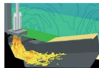
Simulation CEDRE de dispositifs de réduction d'onde de souffle au décollage pour réduire la sollicitation acoustique des charges utiles
