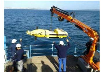
Démonstration d'une architecture décisionnelle ONERA dans l'AUV Daurade (véhicule DGA/TN)
