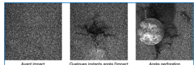
Une bille rigide impacte la face opposée à la mesure ; un mouche-tis a été appliqué sur la plaque afin de mesurer ses déplacements mais également sur la bille ce qui permet d'évaluer sa vitesse résiduelle après perforation
