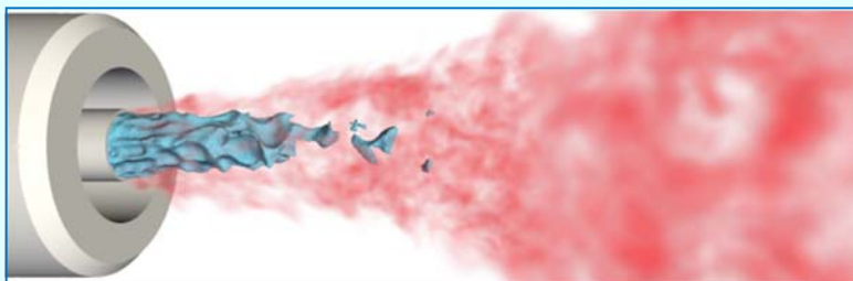
Simulation Mascotte : phase dense (bleu) et spray résultant de l'atomisation du dard liquide (rouge)
