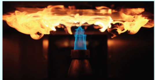
Suivi de la forme d'une plaque composite soumise au feu. Collaboration entre THERMOSOLEX et la convention ONERA/DGAC PhyFIRE
