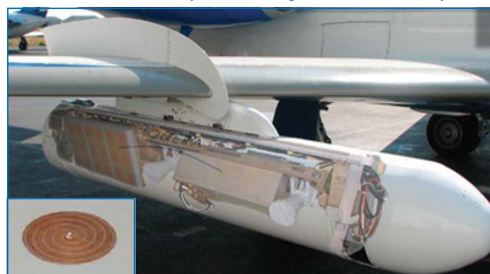
TANGER Antenne réseau imprimée très large bande et antenne spirale
