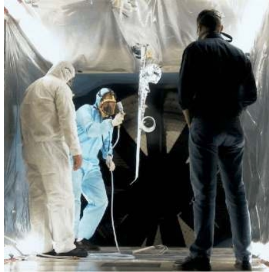
Figure 3: peinture en veine d'une maquette d'A340 par l'équipe PSP du DLR (dans la soufflerie LSWT de la DASA à Brème). Image fournie par le DLR.
