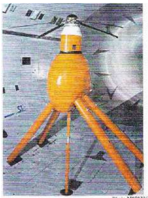
Rotor à pales en flèche optimisées dans la soufflerie S1MA
