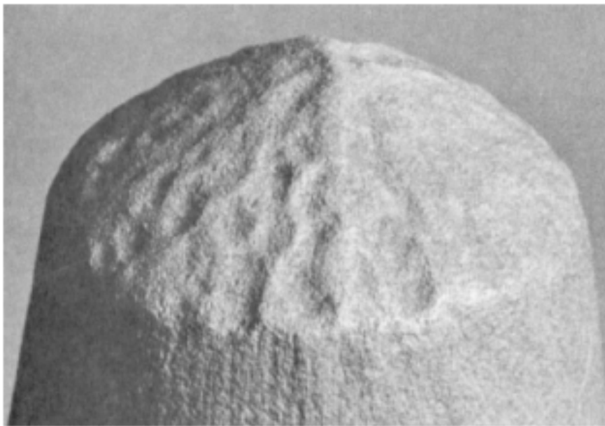
Coups de gouge sur la pointe avant de l'essai en vol TATER (Hochrein & Wright, 1976)
