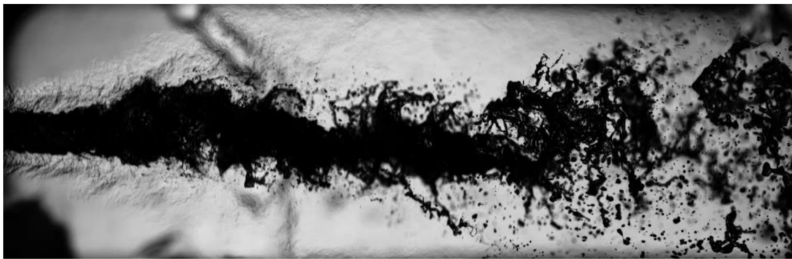
Figure 1 : visualisation instantanée montrant le processus d'atomisation lors de la combustion d'oxygène liquide/méthane sur le banc d'essai MASCOTTE
