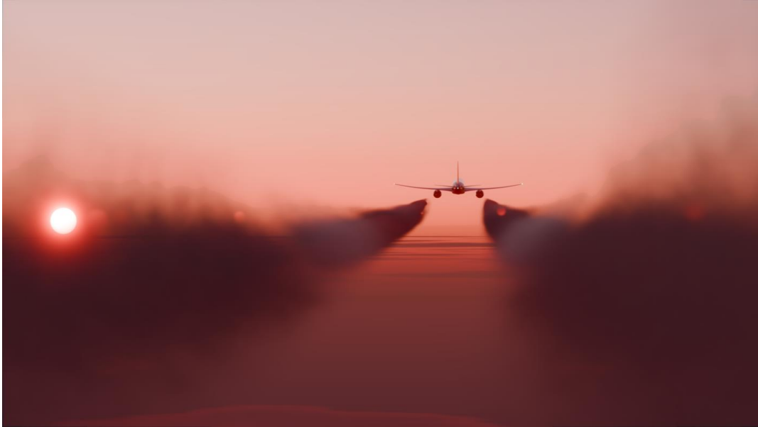
Rendu photoréaliste d'une traînée de condensation calculée via une simulation RANS
