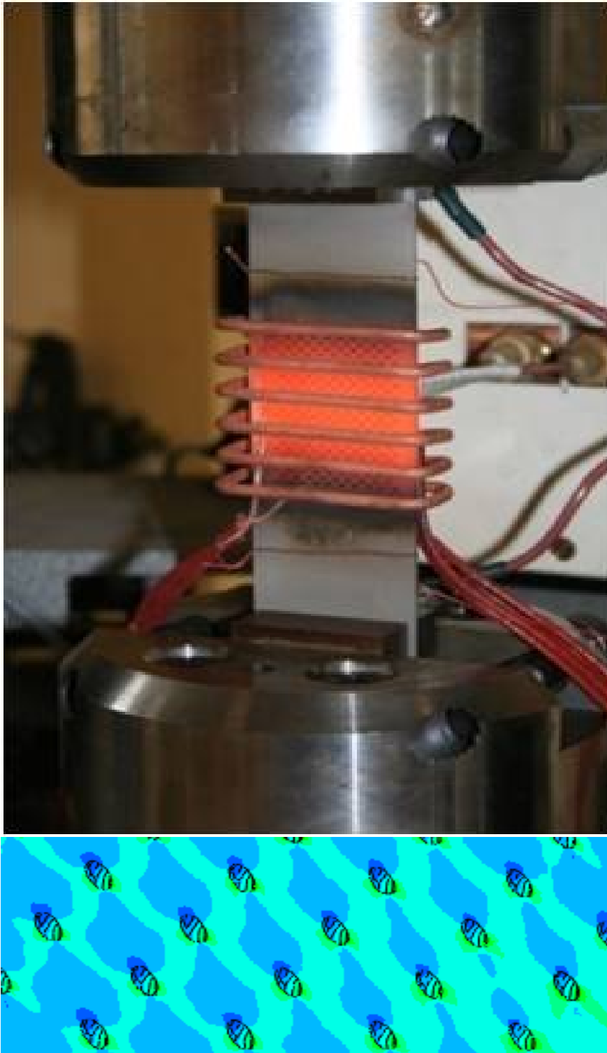
Figure 1 : en haut, l'éprouvette multiperforée sollicitée en traction-compression isotherme – en bas, résultats du calcul correspondant
