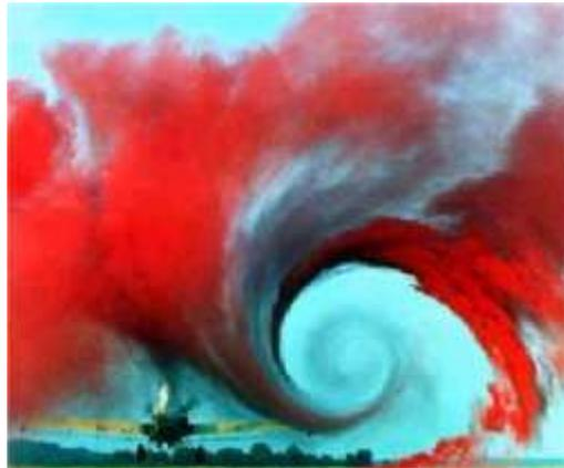
*Fig 5 : Visualisation des tourbillons de sillage consécutive au passage d'un avion léger à travers un panache de fumée*
