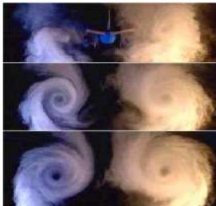
*Fig 4 : Visualisation des tourbillons de sillage par catapultage d'une maquette au travers un panache de fumée. La maquette se déplace vers l'arrière de la figure (Source : Onera)*
